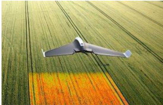
**Figura 9.** Dron de ala fija realizando un vuelo sobre un cultivo. Fuente: Disco, il drone per l'agricoltura chiavi in mano - Agrimeccanica - AgroNotizie (imagelinenetwork.com)
