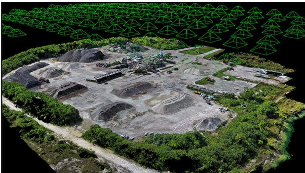
**Figura 1.** Modelo del terreno obtenido a partir de un vuelo fotogramétrico. Fuente: •▷ 【 10 consejos para principiantes en la fotogrametría 】 » HispaDrones
