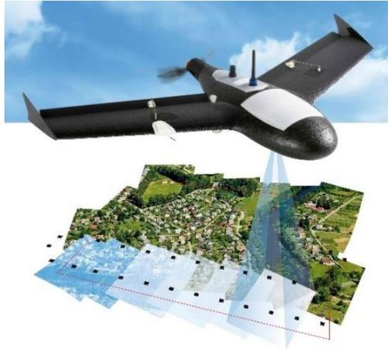
**Figura 30.** Representación de un vuelo fotogramétrico con dron de ala fija sobre un área urbanizada.
