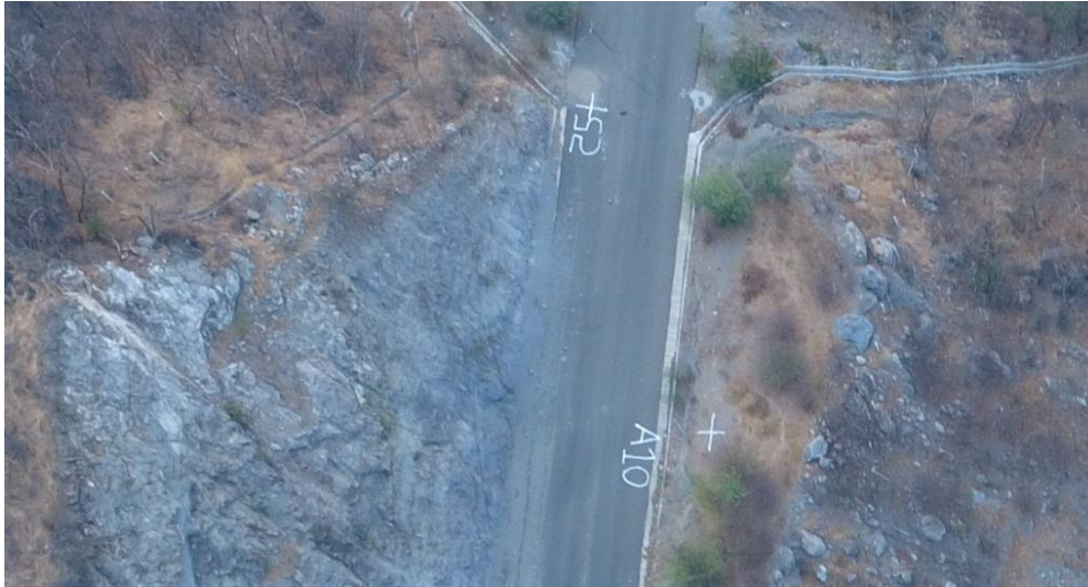
Fig 13. Puntos dibujados en campo para el vuelo de dron [Fotografía], Dominio personal, 2023.
