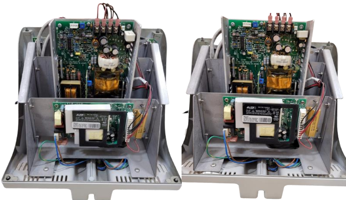
Figura 13. Tapa superior retirada para comenzar a realizar el reemplazo.
