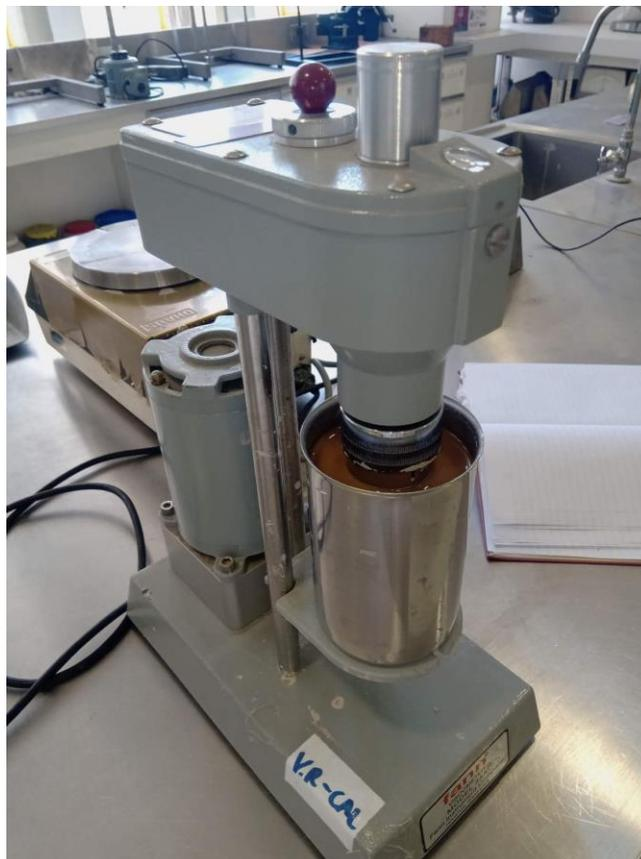
**Figura 30. Viscosímetro de FANN, (laboratorio de elementos de perforación, 2022)**
