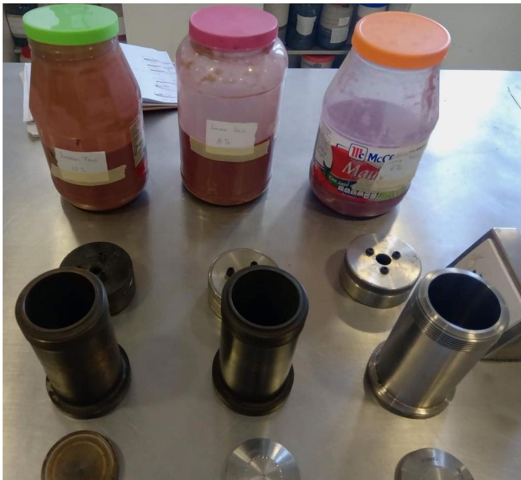
**Figura 33. Pruebas antes de ingresarlas al horno rolador. (Laboratorio de elementos de perforación, 2022)**
