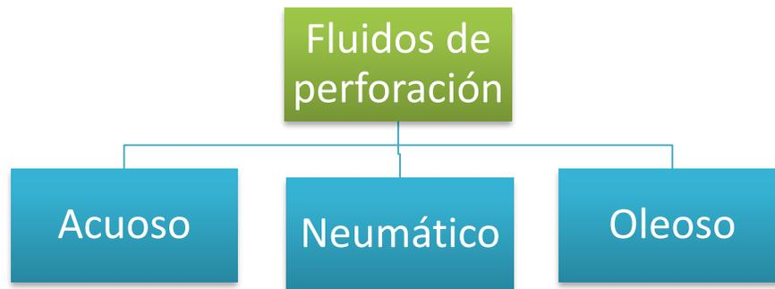
**Figura 14.** Clasificación de los fluidos de perforación de acuerdo con su base.
