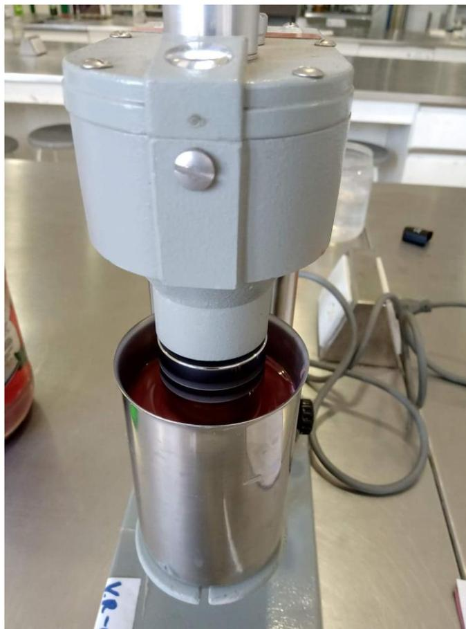
**Figura 29. Medición de la reología de las pruebas y la toma de datos.
