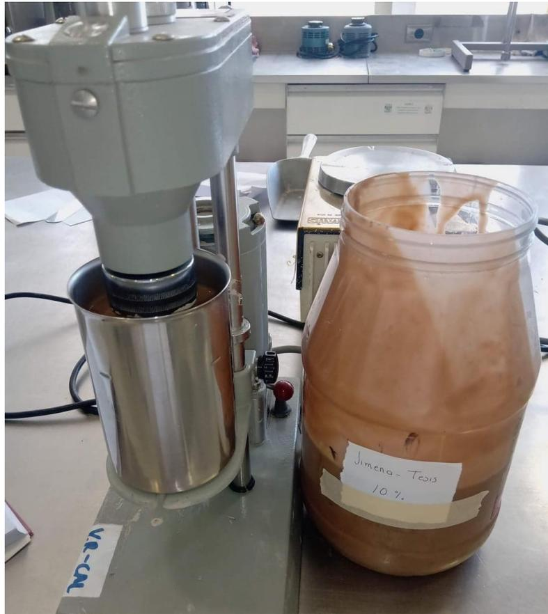
**Figura 31. Prueba de reología (Laboratorio de elementos de perforación, 2022)**
