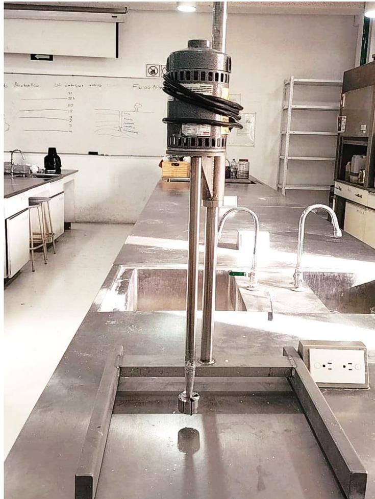
**Figura 20. Dispensor de lodos (Laboratorio de elementos de perforación, FI, UNAM, 2022).**
