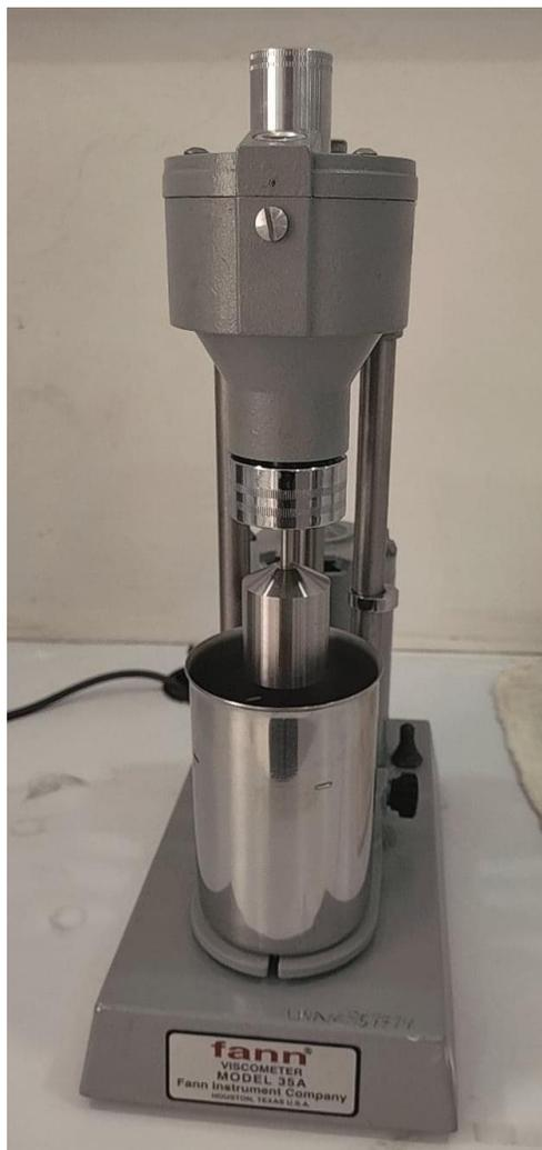
**Figura 17: Viscosímetro de Fann, (Laboratorio de elementos de perforación, FI, UNAM, 2022).**
