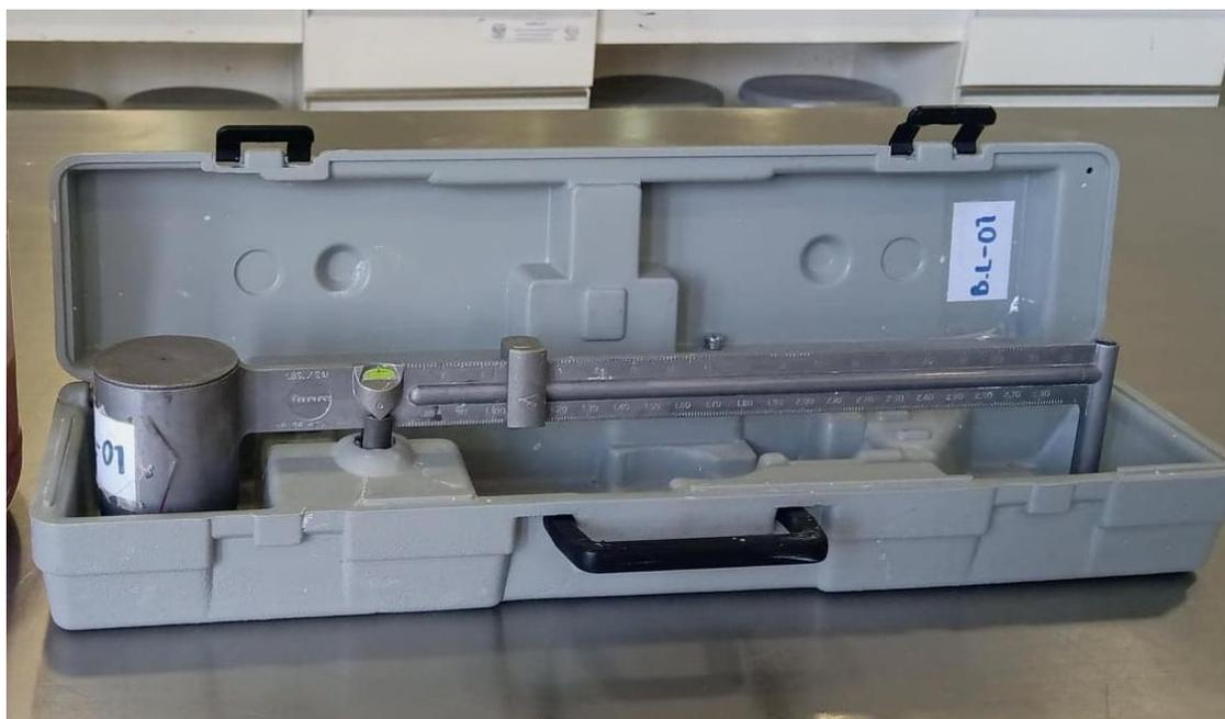
**Figura 15. Balanza de lodos, (Laboratorio de elementos de perforación, FI, UNAM, 2022).**
