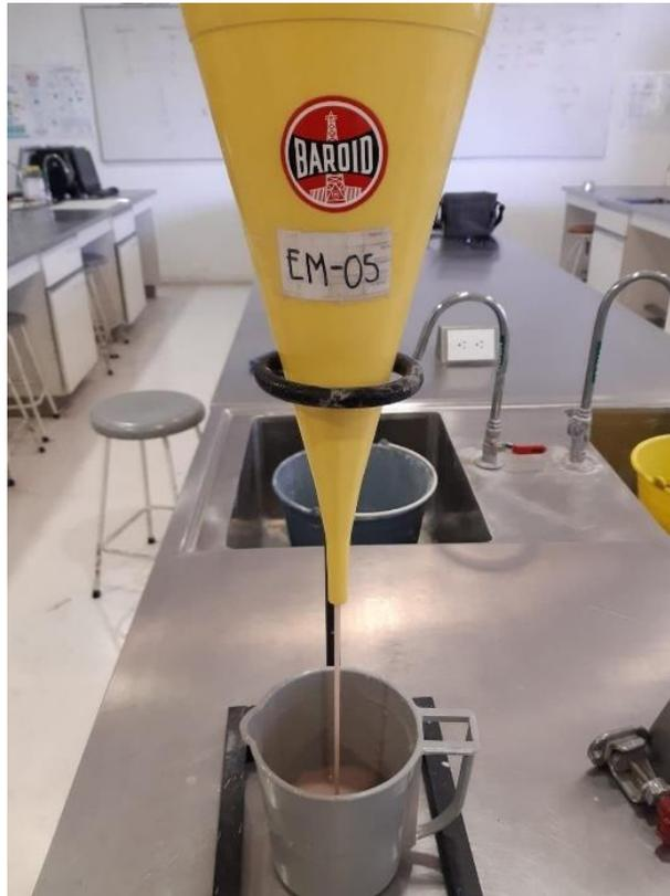
**Figura 16. Embudo de Marsh, (Laboratorio de elementos de perforación, FI, UNAM, 2022).**
