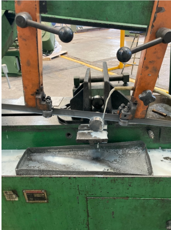
Figura 21. Corte de las secciones transversales de la barra de acero inoxidable de 2 pulgadas.
