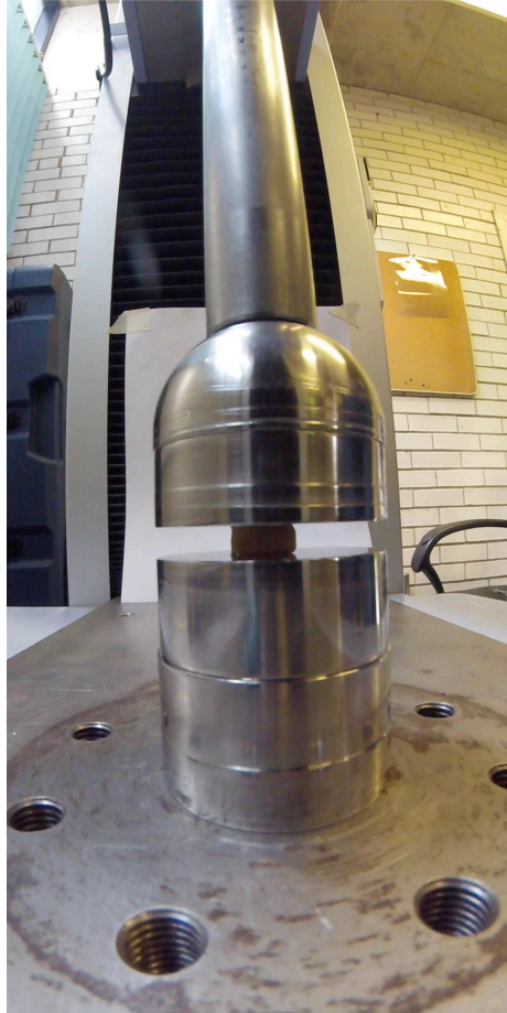
Figura 25. Ensamble del modelo de pruebas de compresión con una probeta preparada para prueba.
