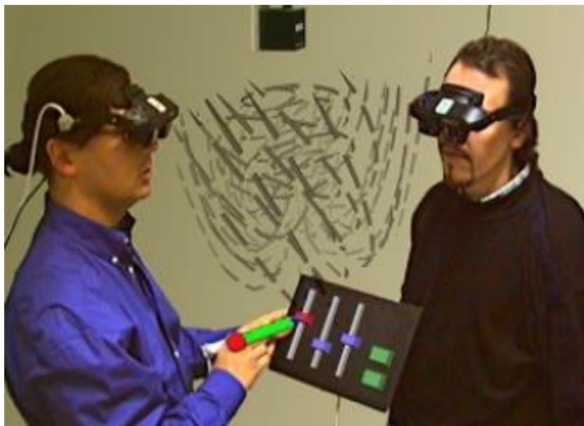
Figura 1. Se muestran dos colaboradores usando lentes de realidad mixta, mientras visualizan un set de datos de flujo e interactúan con él por medio de un panel y una pluma magnéticos. Fuente: (Schmalstieg et al., 2002)
