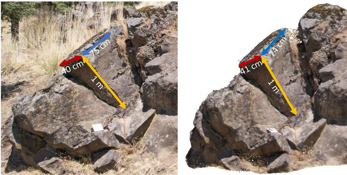
Figura 3.31 Comparativa entre una fotografía y la nube de puntos de una misma zona en el afloramiento Colada La Cima II.
