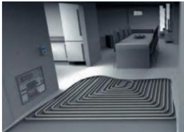
Figura 2.9. Suelo radiante (Fundación de la Energía de la Comunidad de Madrid, 2014)
