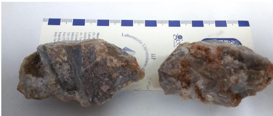
Figura 5.13. Muestra de mano correspondiente a la zona de silicificación.
