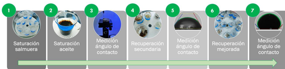
Figura 20: Metodología de prueba de ángulo de contacto
