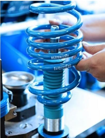
Ilustración 6 Ejemplo de la posición montaje de resorte en amortiguador. ©Bilstein of America.
