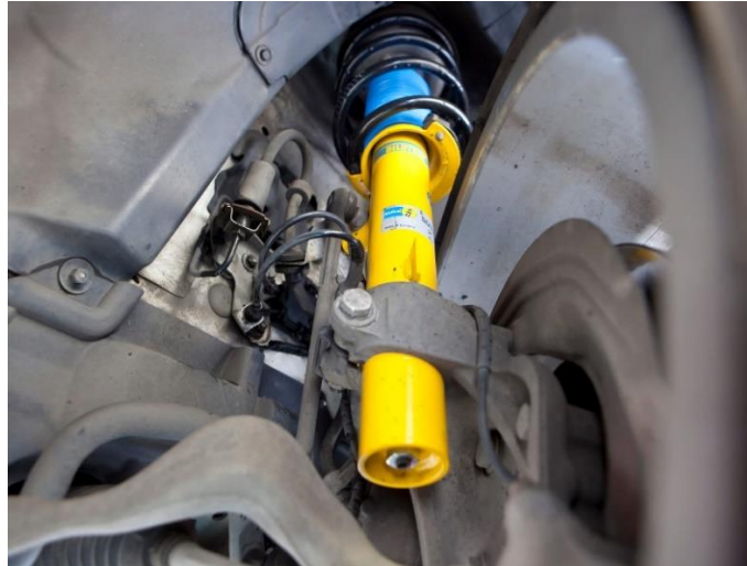
Ilustración 2 Amortiguador Bilstein monotubo montado en suspensión de un automóvil. ©Bilstein of America.
