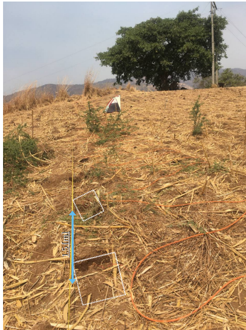
Figura 4.5: Fotografía que muestra una porción del levantamiento de prospección eléctrica, se resaltan las placas utilizadas como electrodos.
