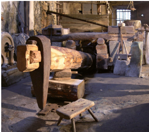
FIGURA 19. Imagen de un antiguo árbol de levas de un herrero
