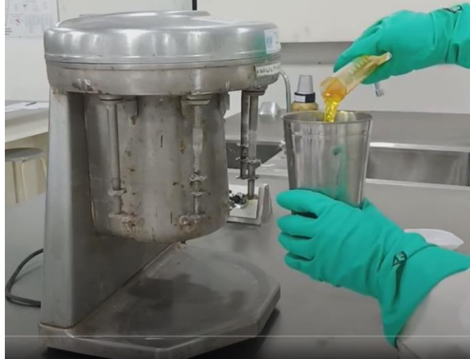
Figura 15 Multimixer, equipo de mezclado de los fluidos base aceite en el laboratorio de fluidos de perforación.
