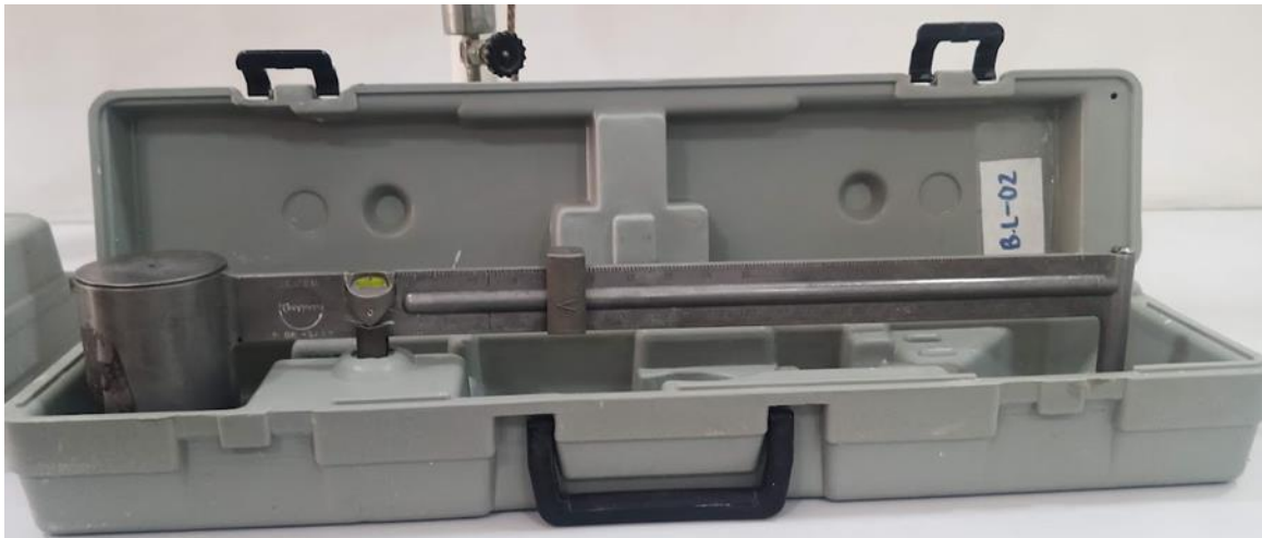
Figura 2 Balanza hidrostática de lodos, marca FANN
