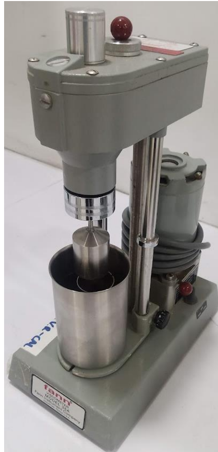
Figura 23 viscosímetro rotacional, marca FANN, modelo 35
