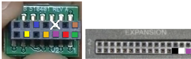
(a) Adaptador de 14 pines con indicadores de pines (b) Adaptador de expansión con indicadores de pines
