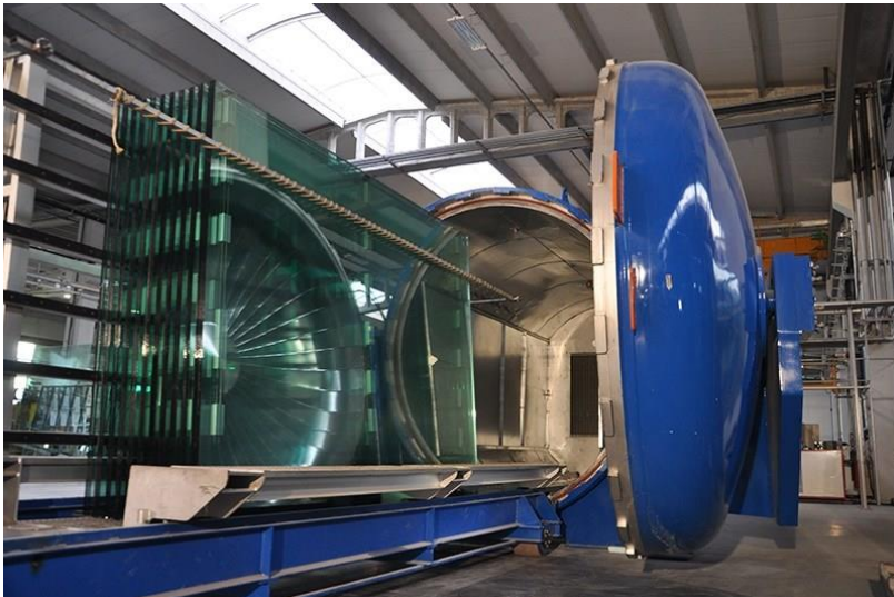
Fig 17. Autoclave. Aparato para esterilizar por vapor que consiste en un recipiente cilíndrico, de paredes resistentes, metálicas, y con cierre hermético autoclave, en cuyo interior, que contiene un líquido, generalmente agua, el objeto se somete a presiones y temperaturas elevadas sin llegar a hervir
