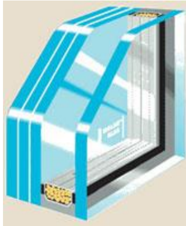
Fig. 29 vidrio insulado con triple laminado y monolítico
