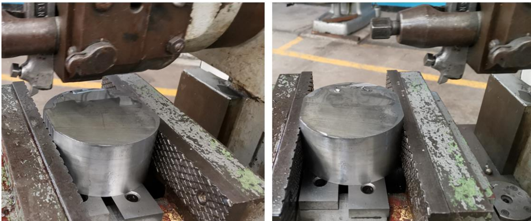
Figura 31. Operación de careado, en máquina cepilladora.
