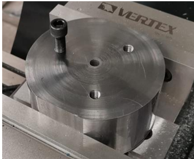
Figura 44. Resultado del roscado de barrenos en el punzón.
