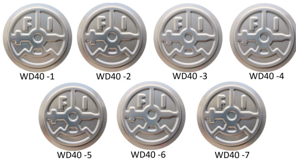
Figura 78. Discos de aluminio, producto de operación de estampado con WD-40® como lubricante.
