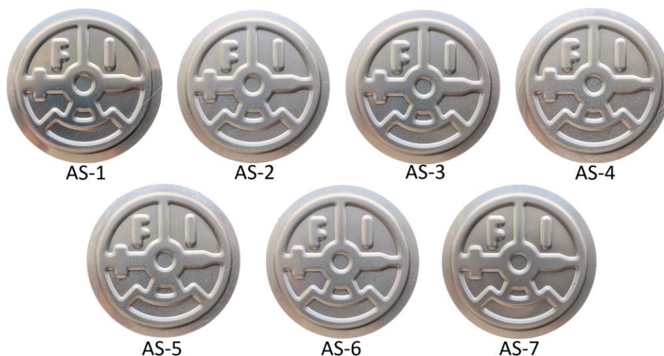
Figura 80. Discos de aluminio, producto de operación de estampado con Aceite Soluble como lubricante.
