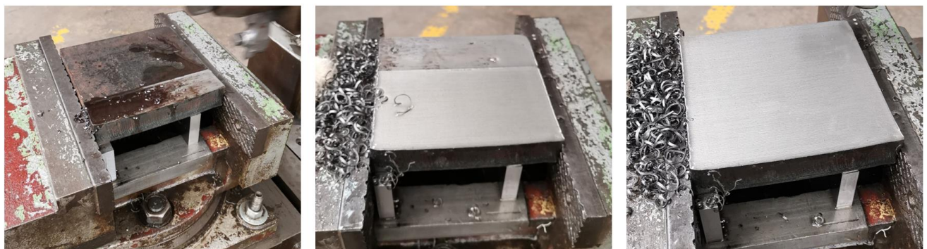
Figura 32. Proceso de cepillado aplicado en placa ASTM A36, para usarse como porta punzón y porta matriz.
