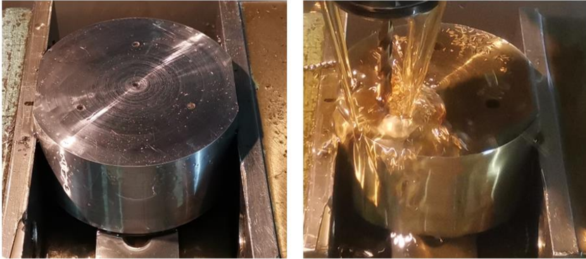
Figura 43. Maquinado de barrenos para ensamble en el punzón.
