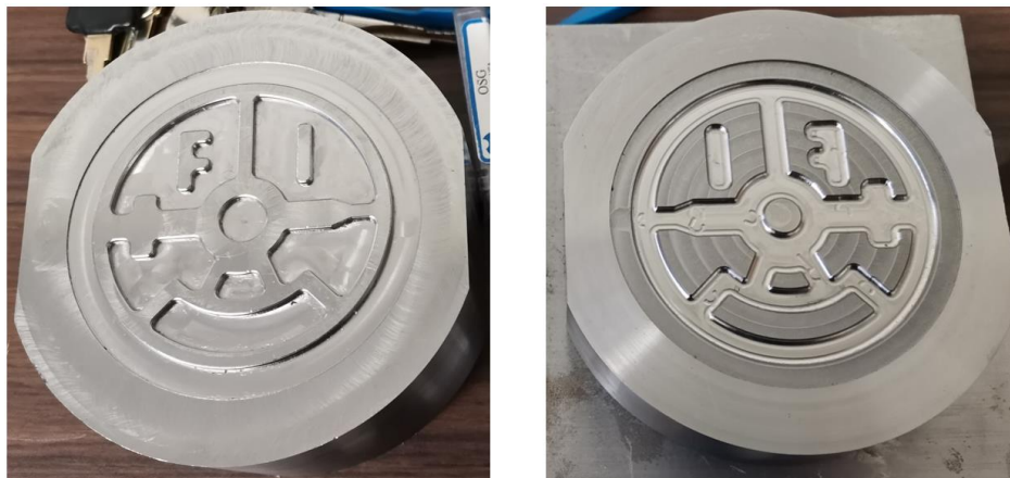
Figura 84. Resultado de maquinado para punzón (izquierda) y matriz (derecha).
