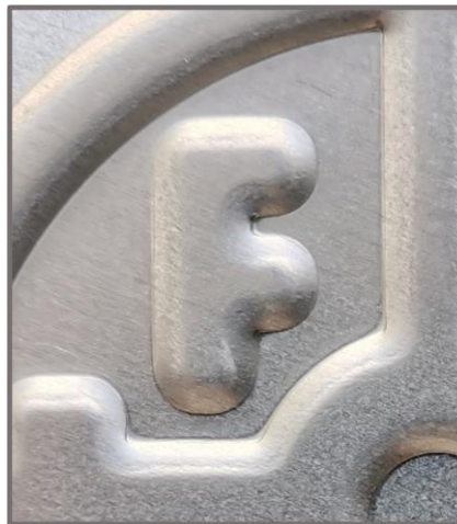
Figura 90. Acercamiento a letra "F" en pieza de aluminio estampada con troquel "escudo FI" en laboratorio de la Facultad de Ingeniería.
