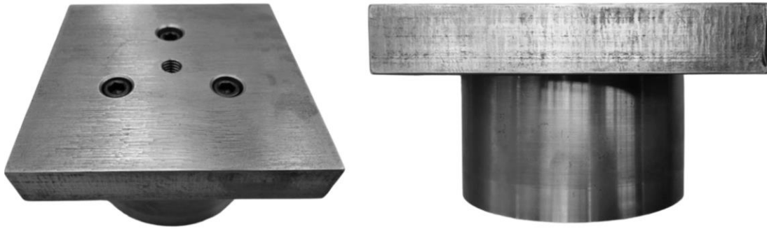
Figura 86. Maquinado en placas porta punzón y placa porta matriz.
