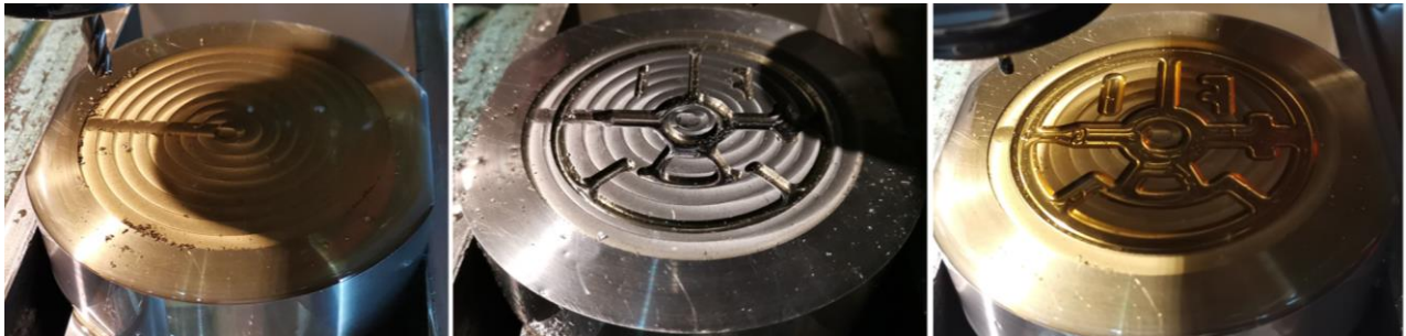
Figura 36. Imágenes de la matriz, durante las diferentes etapas de maquinado en máquina VMC 300.
