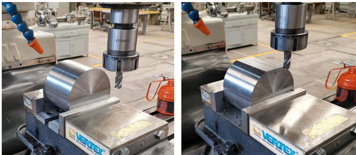
Figura 30. Montaje y maquinado del tocho en fresadora vertical convencional.
