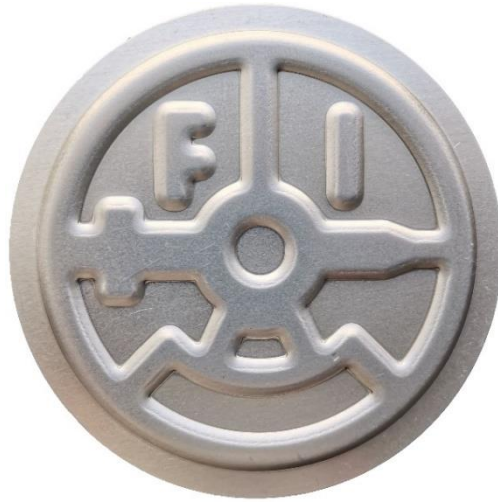
Figura 89. Muestra de la alineación entre punzón y matriz, revelada por las marcas dejadas por el troquel y la matriz durante la operación de estampado.
