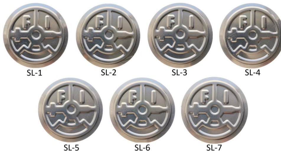
Figura 76. Discos de aluminio, producto de operación de estampado sin lubricante.
