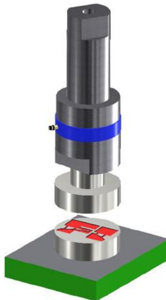
Figura 18. Ensamble de Troquel para Estampado, diseñado por el Ing. Eduardo Cuevas. [11]
