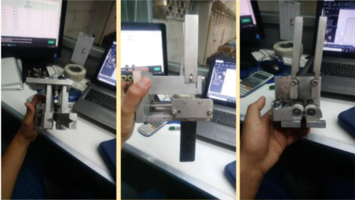
Fig. 6.8 Fotos para el levantamiento del sistema de tracción para maquina etiquetadora
