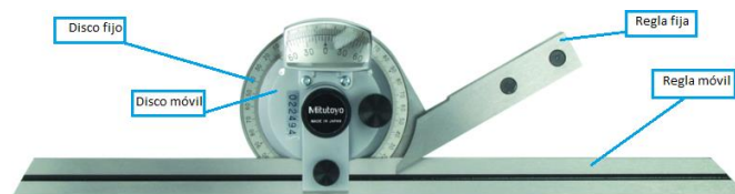
Fig. 5.11 Partes principales de un goniómetro
