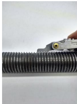
Fig. 5.16 Uso del calibre de roscas
