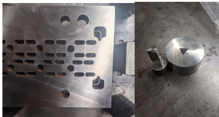
Fig. 5.4 Matrices para troquel fabricadas mediante electroerosión con hilo
