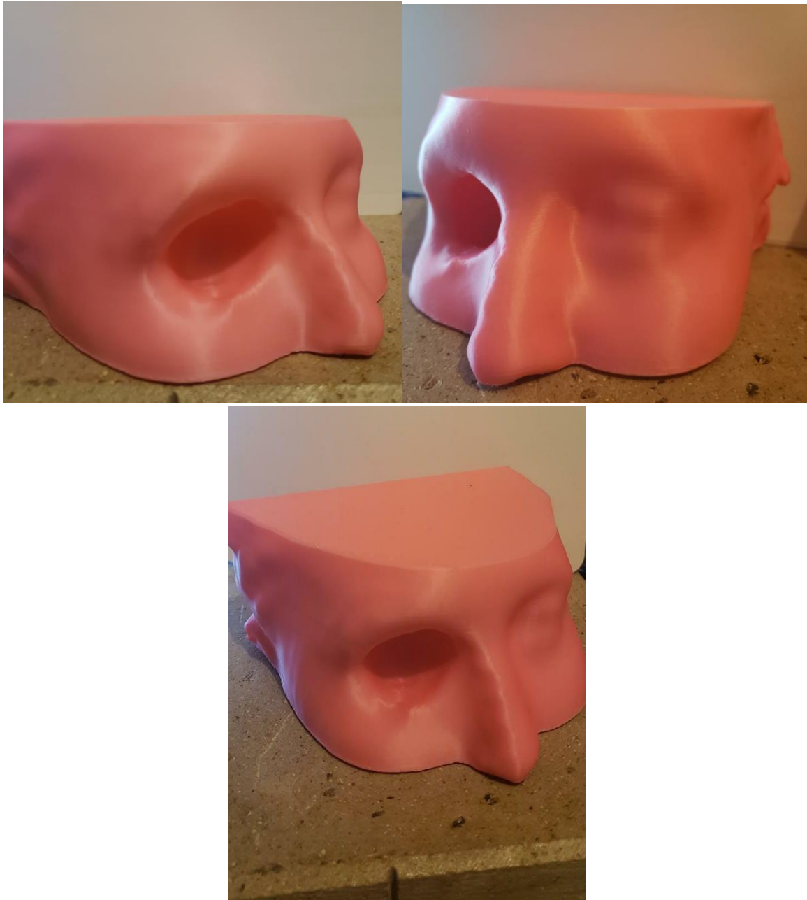
Figura 32. Modelo impreso en PLA, resultante del escaneo y recorte.
