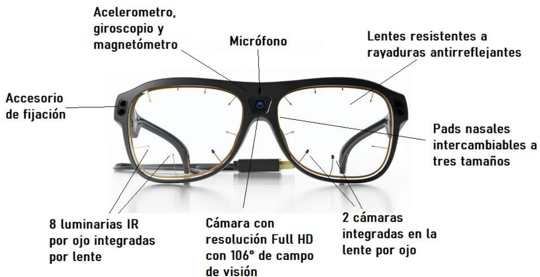
Figura 22. Vista isométrica de Tobii Pro Glasses. Se muestran los aditamentos con los que cuenta el dispositivo, tales como micrófono, acelerómetro, giroscopio, magnetómetro, dos cámaras Full HD integradas para cada lado, cojinetes nasales intercambiables a tres tamaños, ocho fuentes de luz integrada para cada ojo y mica antirreflejante, así como su un puerto USB para la carga de la batería. Diagrama traducido y modificado. [27]
