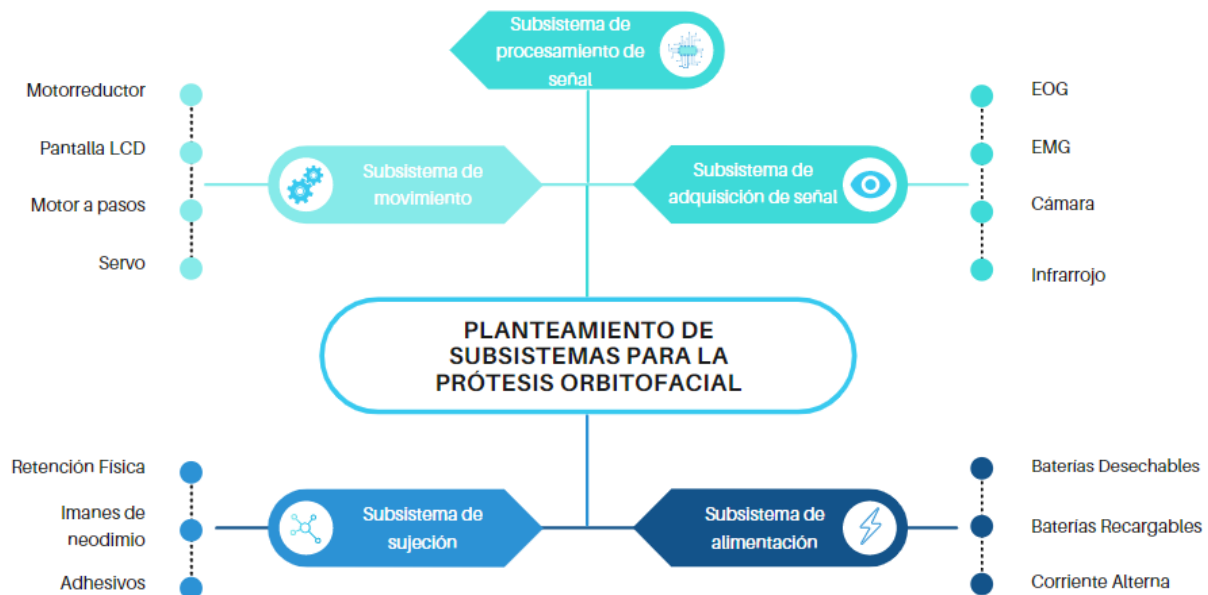
Figura 19. Diagrama que resume y sintetiza las posibles soluciones a cada uno de los subsistemas. Posteriormente, en la etapa de selección de concepto se procederá a filtrar las opciones, con el fin de elegir una combinación, así como analizar su compatibilidad.
