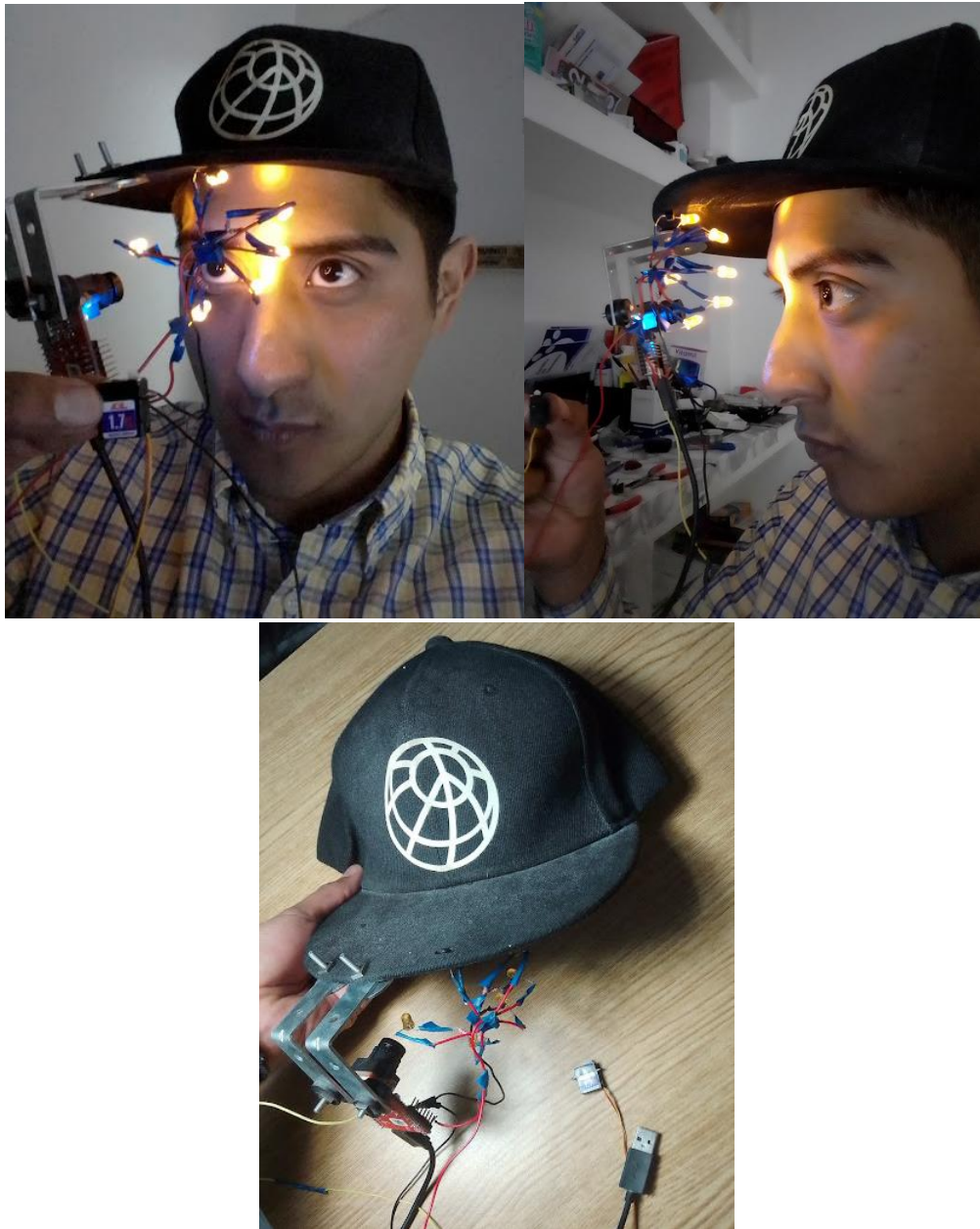
Figura 41. (Superior izquierda) Imagen frontal del sistema trabajando en un ambiente con poca iluminación. (Superior derecha) Imagen del perfil del sistema trabajando. Se puede apreciar que el arreglo de LED ilumina correctamente la región, así reduciendo el ruido generado por la poca iluminación ambiental. (Inferior) Apariencia inicial del sistema apagado.
