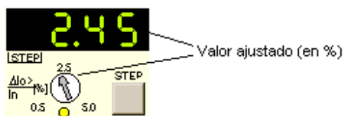
Fig. 7.20 Ajuste del valor de la corriente diferencial. 95
