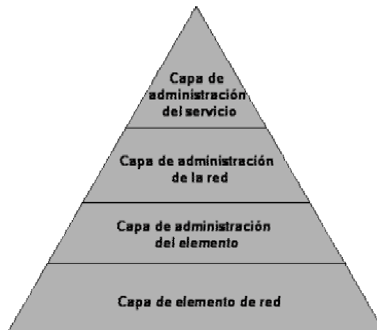
Figura 5.5 Modelo TMN para la gestión de equipos SDH.
