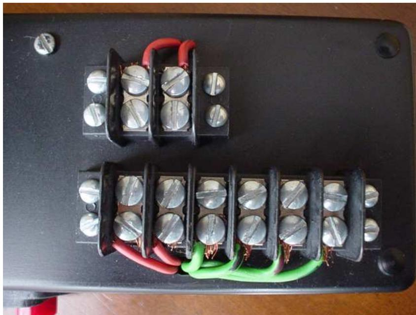
Figura 5.7: Panel de conexiones de la interfase
