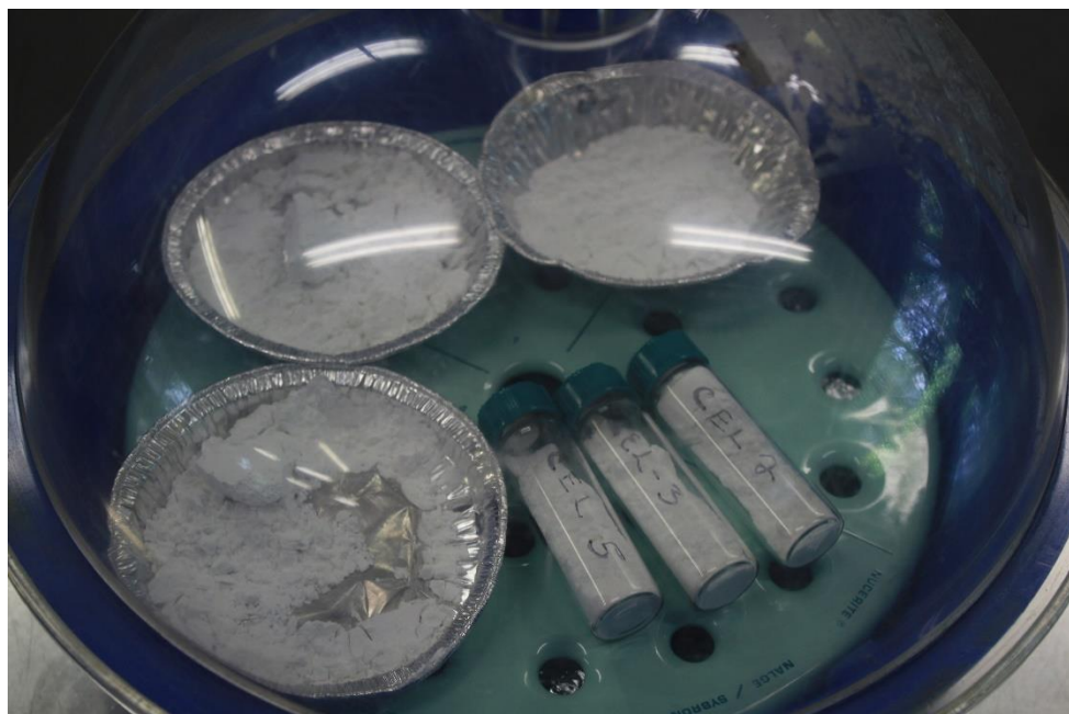
Imagen 8 Muestras de diatomea para análisis por microscopio electrónico de barrido.
