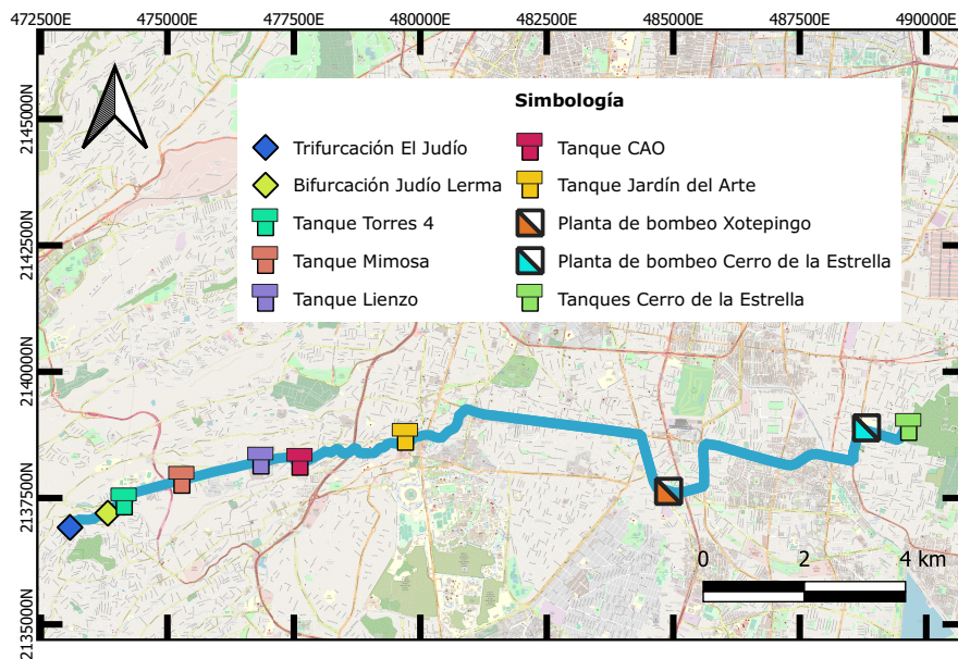
Fig. 3.1: Infraestructura de la línea de red primaria desde la Trifurcación Judío hasta los Tanques Cerro de la Estrella. Fuente: Elaboración propia
