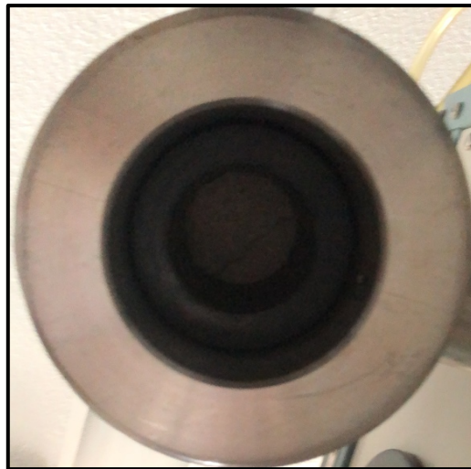
Imagen 8. Ensamble Portamuestras-manga de hule-muestra.
