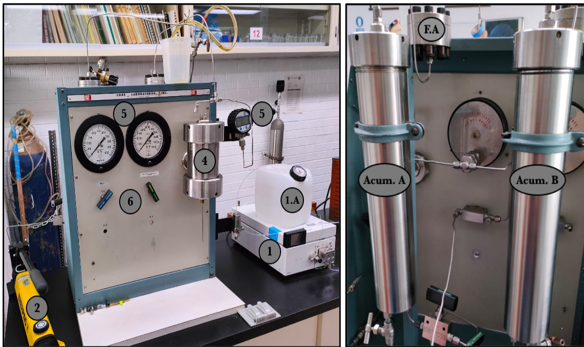
Imagen 1. Vista completa de frente (izquierda) y detrás (derecha) de la celda y sus principales elementos.
