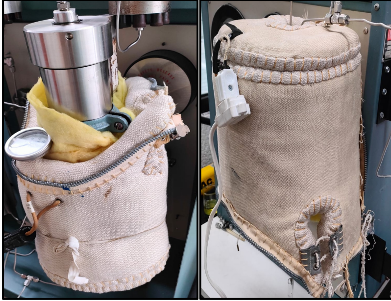
Imagen 11. Acumulador del aceite cubierto por fibra de vidrio y abrazado por una manta térmica (izquierda). Portamuestras cubierto por fibra de vidrio y abrazado por una manta térmica (derecha).
