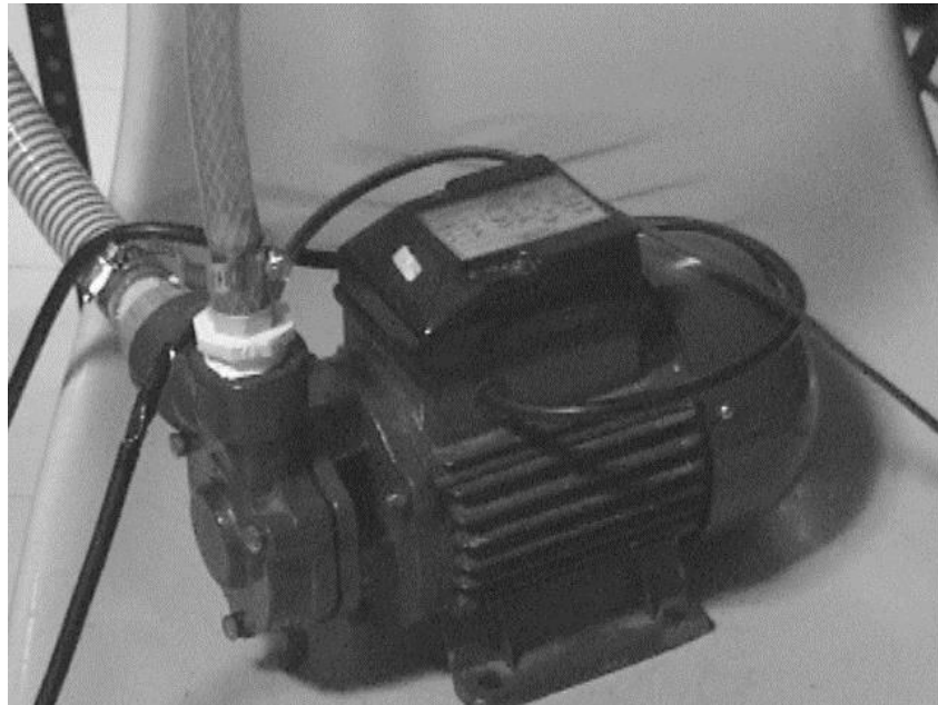
Fig. 3.7. Bomba F&Q Pumps, modelo HT300, de 3/4 HP.
