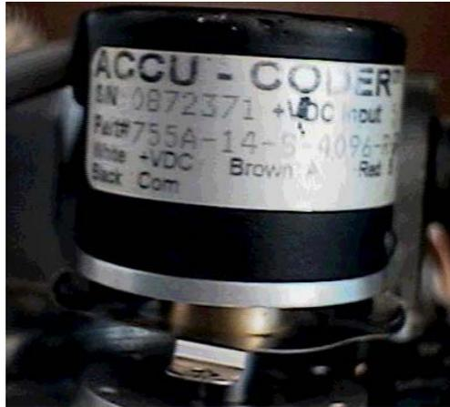
**Fig. II.8.- Codificador ACCU CODER**
