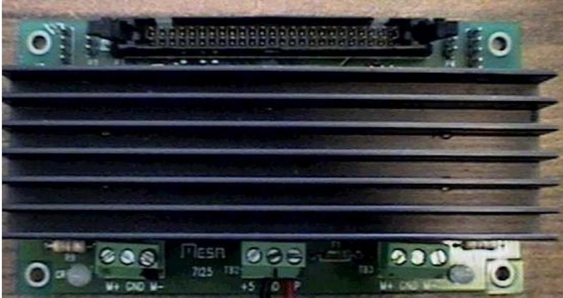
**Fig.II.9.- Tarjeta 7125: puente H bicanal**
