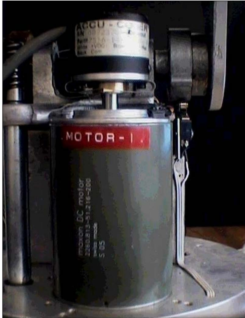
*Fig. III.2.- Motor Maxon una vez instalado en el pedestal*
