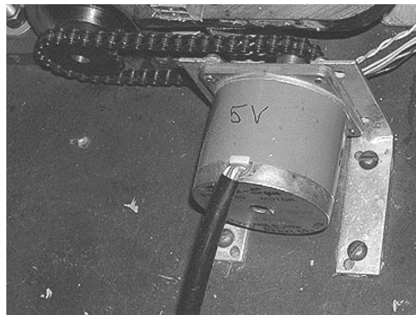
Figura 3-11 Motor para el desplazamiento de la banda.
