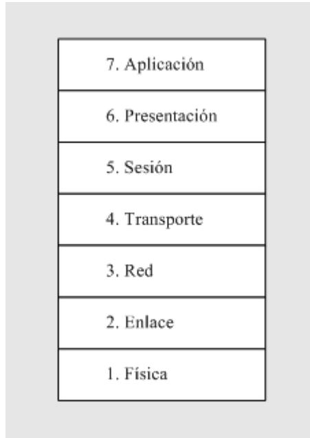
Figura 2.1 Las capas del modelo OSI
