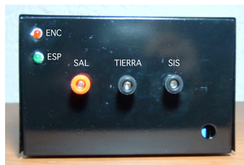
Figura C.4: Descripción de terminales del panel delantero.
