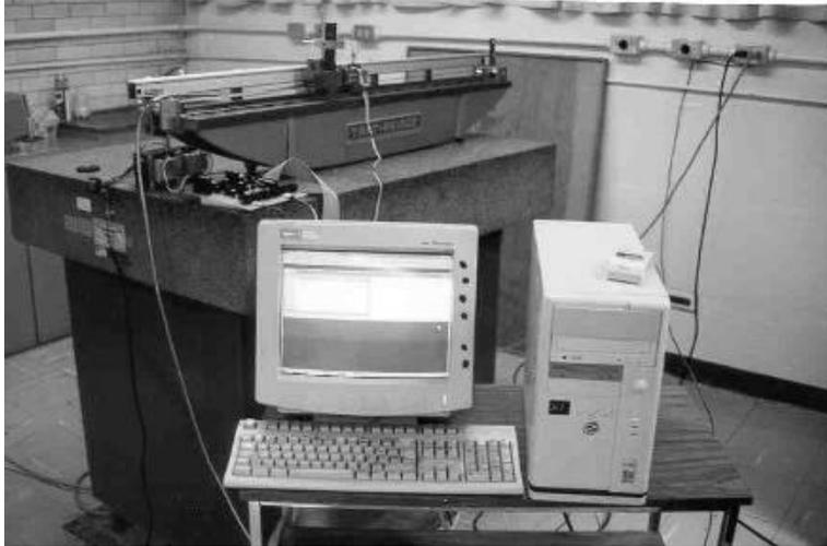
**Figura 1.** Máquina para la calibración de escalas graduadas.
