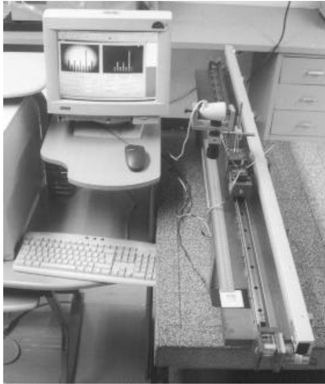
**Figura 5.10.** Máquina para la calibración de escalas graduadas utilizando visión por computadora y posicionamiento automático.
