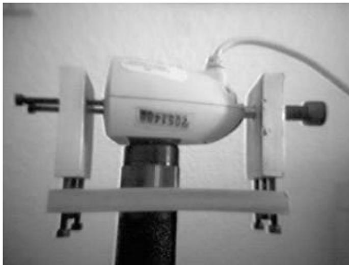
**Figura 3.4.** Base para acoplar la cámara al microscopio.
