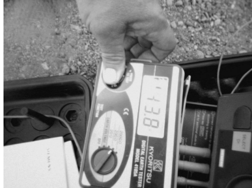
Figura 43. Mediciones de resistencia del terreno.
