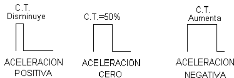
Figura 6.21(a) Variaciones del ciclo de trabajo debidas a las variaciones de la aceleración
