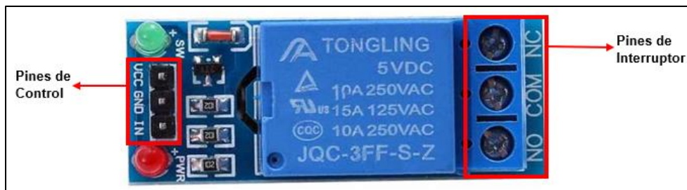
Figura 7.3.3: Pines de un Relé. Tomado de "Relé con Arduino y ESP8266 para crear una lámpara inteligente" por ProgramarFacil, https://programarfacil.com/blog/arduino-blog/rele-con-arduino-lampara/
