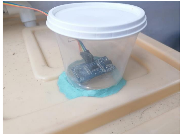
10.3.3.20: Sensor en el contenedor de solución nutritiva NFT
