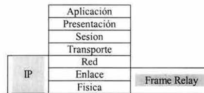
Figura 4.1.2 Niveles utilizados por Frame Relay e IP
