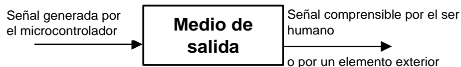
Figura 2.2: Propósito de los medios de salida.
