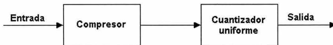
**Figura 5.14.** Diagrama de bloques de un cuantizador no uniforme. Primero se le aplica una función de compresión a la señal de entrada, para después pasarla por un cuantizador uniforme y obtener la salida.
