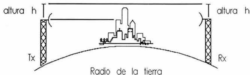
Figura 1.3.2.1 Altura  $h$  del Obstáculo Debida a la Curvatura de la Tierra.
