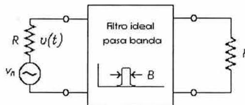
Figura 4.7.1.2. Circuito Equivalente de Thévenin de la Resistencia de Ruido.
