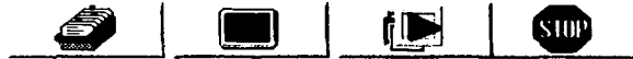
Figura 3.4. Botones de acción Abre archivo SIL , Depurar archivo SIL , Iniciar la simulación y Detener la simulación en la parte central del panel principal.
