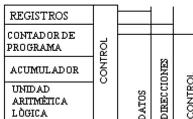
Fig.6.6 Diagrama de bloques de un microprocesador
