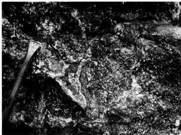
Fig. 4.3. Brecha mineralizada de óxidos de manganeso, dolomita color rosa-amarillo y minerales arcillosos en una brecha volcánica basáltica.
