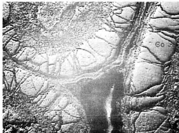
Fig. 4.14. Textura colorforme-esferoidal de la coronadita (Co) (Briqueta Gav-3E). Luz reflejada, sin analizador. Amplitud del campo 2500 μm.
