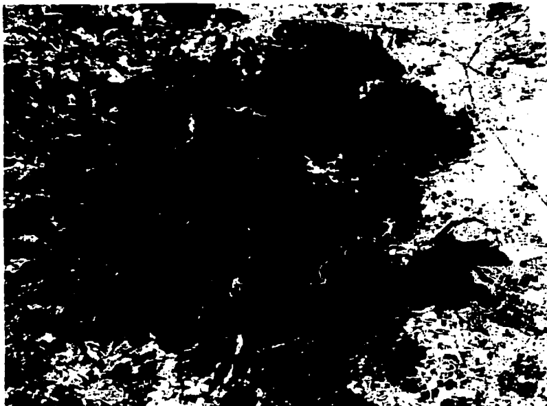
Fig. 5.8 Imagen de la banda 1 TM de la imagen del oeste de Guadalajara realizada linealmente con saturación del 5%.
