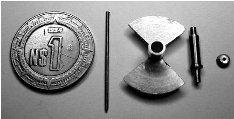
Figura. 4.10 Partes del encoder
