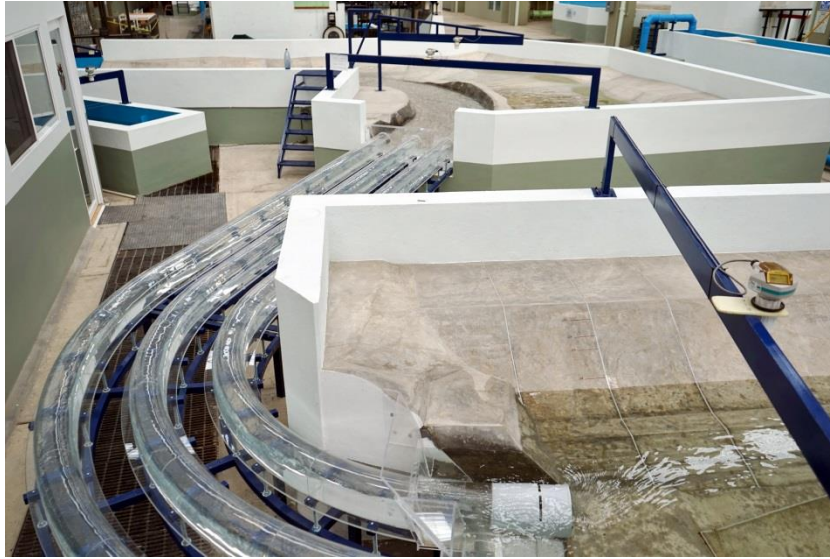
Imagen 3. 3 Modelo físico escala 1:92 de la obra de desvío del proyecto hidroagrícola de la presa de almacenamiento Santa María, IMTA.
