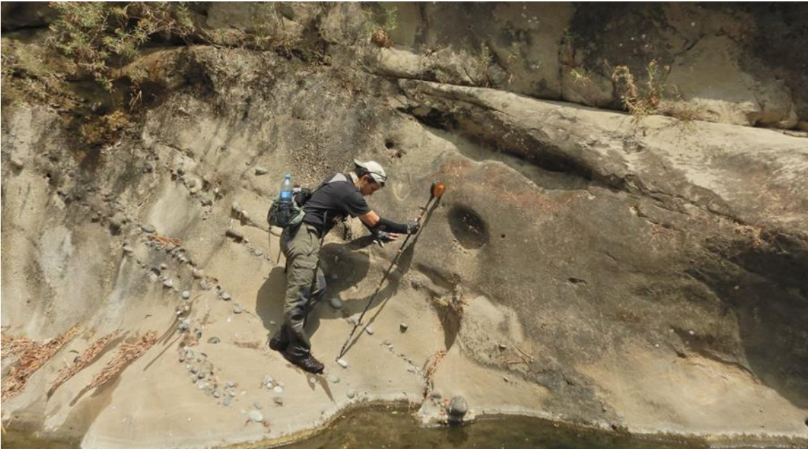
Figura 5.2. Fotografía representativa de actividades de campo, que incluyeron la medición de la columna estratigráfica con el báculo de Jacob en la Formación Ixtapa.
