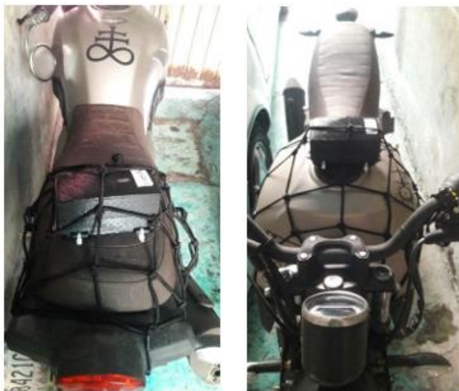
Figura 2.12: Dos formas de asegurar el SEMAV (al tanque y al asiento). Fuente: Creado por el autor.
