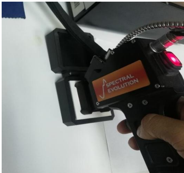
Figura 5. 1186 Imagen del equipo OreXpress (Spectral Evolution) calibrando el equipo antes de realizar el análisis de las muestras.
