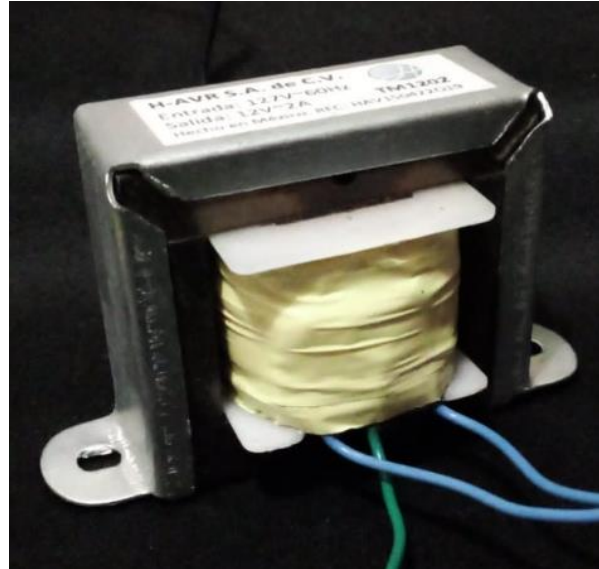
Figura 26. Transformador con el que se diseñó el tamaño de la huella en la PCB.
