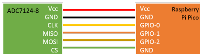
Figura 3.10: Diagrama de conexión para la comunicación SPI.
