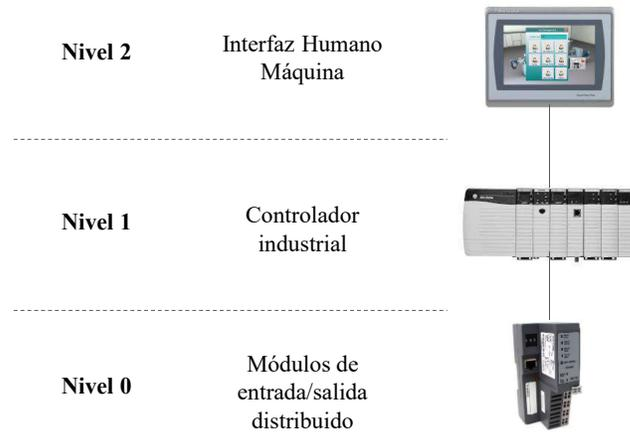
**Figura 2.3.** Dispositivos en la zona de celda/área
